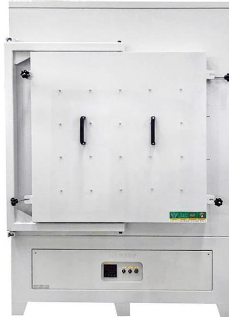
GWL-XL 系列 800-1200 度高温炉如图所示，集控制系统与炉膛一体设计。炉衬使用真空成型高纯氧化铝聚轻材料制作而成。
